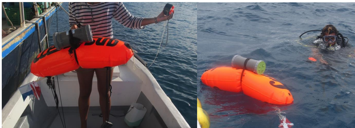
Figure 6 : Traceur GPS fixé sur une bouée reliée au plongeur.
