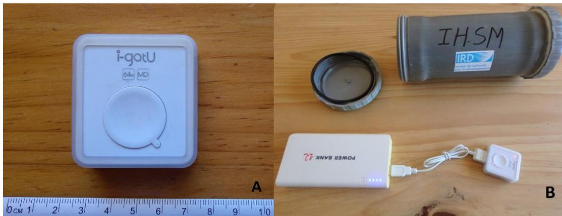
Fig. 12: Traceur GPS i-gotU (A), GPS i-gotU branché à un power bank à incorporer dans un boîtier artisanal (B)
